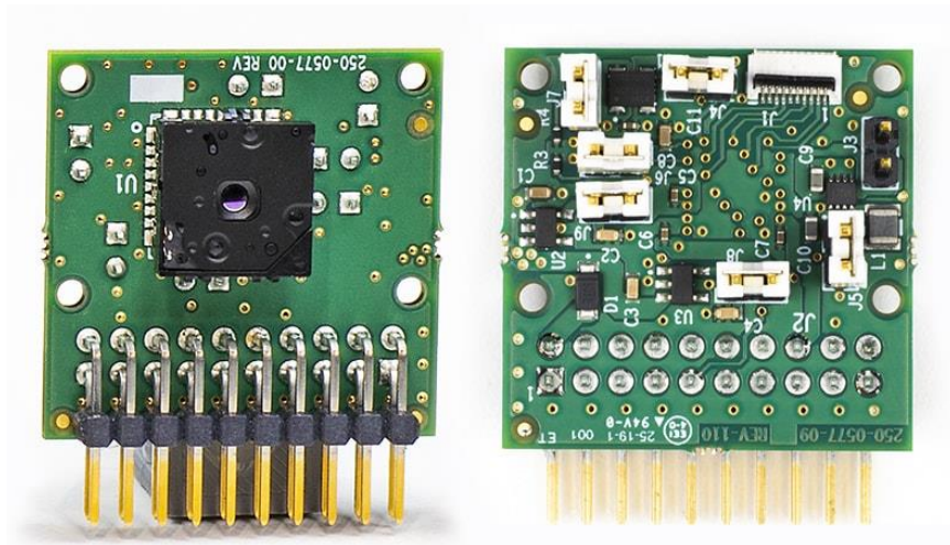
圖 2 紅外線熱影像設備
